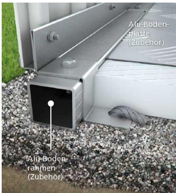
**Bodenbefestigung mit Bodenrahmen im Schnitt**
